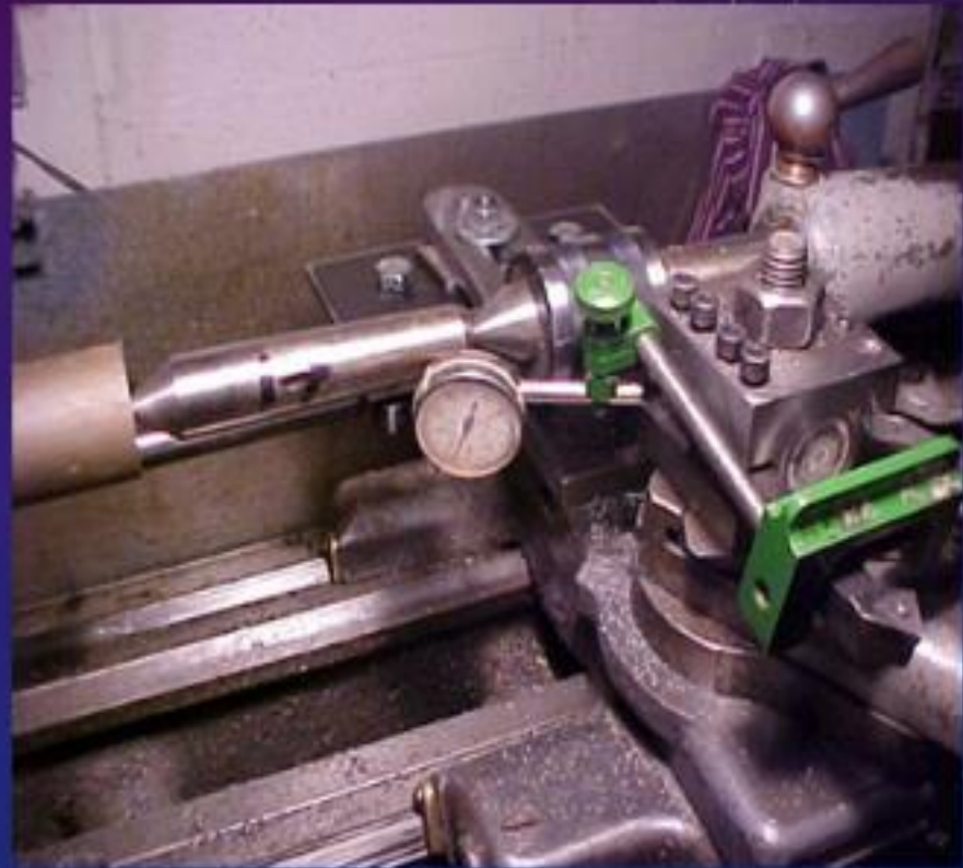
Pengaturan pergeseran eretan atas berbasis batang tirus standar
